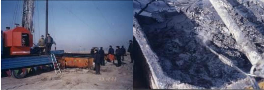
项目评判：目前我国油田尤其是北方油田，普遍采用锅炉车化油，效率低，成本高。阿尔柯特公司与华北油田相干技术人员、美国 ALKOTA 公司总部合作设计开发出一款专用油田高效化油设备，油田热洗车。现场与原有锅炉车同时对不同油池进行化油作业，经比较，新一代热洗车效率高，化油温度高，得到现场一致认同。
