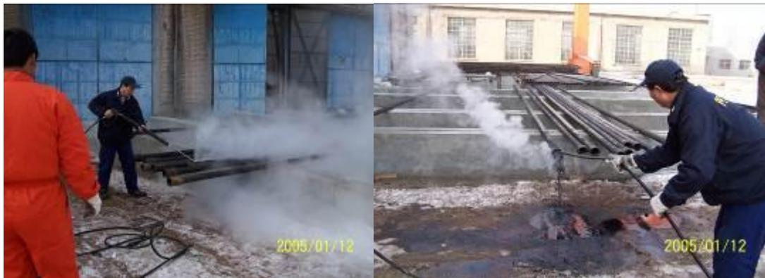
项目评判：油管清洗是所有采油厂都从事的工作之一。目前存在人工清洗与自动清洗两种方式。我们的是前一种，特点是：投资小，方便快捷，机动性强，可移动，一机多用，油罐内外壁均能彻底清洗干净。同时还能用于其他零部件清洗，适合多种作业场合。
